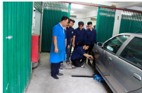
Giáo viên hướng dẫn học sinh kiểm tra hệ thống phanh trên ô tô
