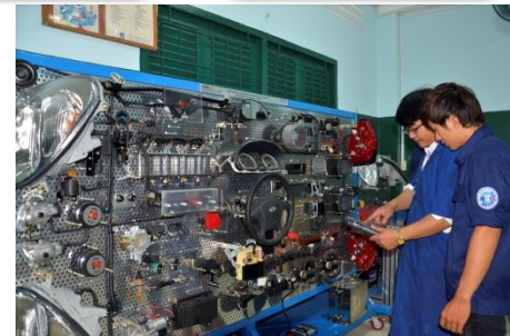
Giáo viên hướng dẫn học sinh chẩn đoán hệ thống điện ô tô
